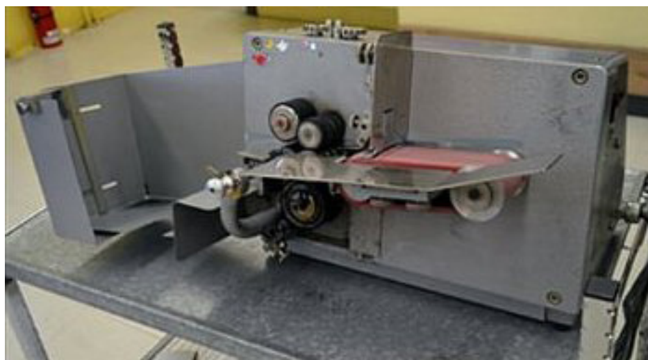
Illustration 9 : Machine à oblitérer Klussendorf de Roberval [Source : Hervé Lachance]
