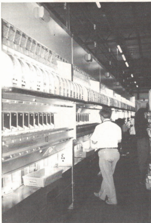
L'autre côté de la MPLSM où l'on peut voir les cases où la machine dépose les lettres selon leur code postal.
